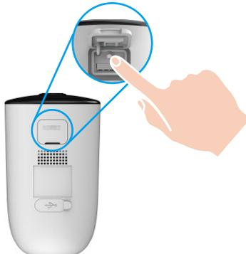
Si se agota la carga de la batería de la cámara, conéctela a la salida de potencia de un adaptador de corriente (5 V y 2 A).
