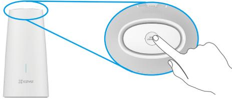
2. Coloque la cámara a una distancia de 30 a 100 cm de la estación base. Mantenga pulsado el botón SINC de la cámara durante 4 segundos. El piloto led parpadeará rápidamente en azul.
